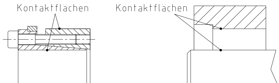
Bild 5: Reinigen der Kontaktflächen (Beispiel: CLAMPEX® KTR 201)
