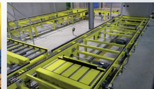
Loop vor einem automatischen Kleinteilelager für Tablare
